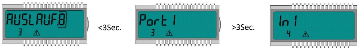
Wenn die Taste für > 6 s gedrückt gehalten wird, führt der Zähler den im Display angezeigten Befehl aus.
